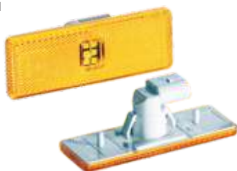
MB Atego I Seitenmarkierungsleuchte mit 6 LED und Rückstrahler, IP67
